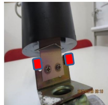
市販の部材でカバーを貼付(赤の部分) モスバリアの損傷防止のため
